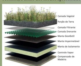
Na imagem, esquema de representação da implantação de telhado verde. Fonte: IAB SP, 2015.
